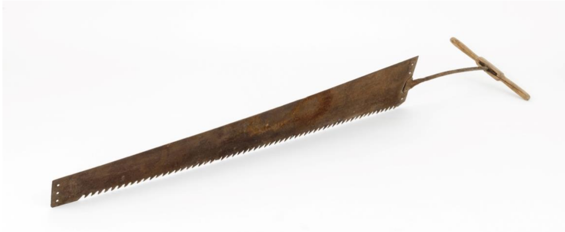
Issag. Saga på bildet ble brukt av Glomma fellesfløtingsforening, trolig ved Fetsund lenser. Den er 153 cm lang og 24 cm bred i den øvre delen. Sagbladet er laget av 2 millimeter tykt valsestål. Foto: Anno Norsk Skogmuseum
