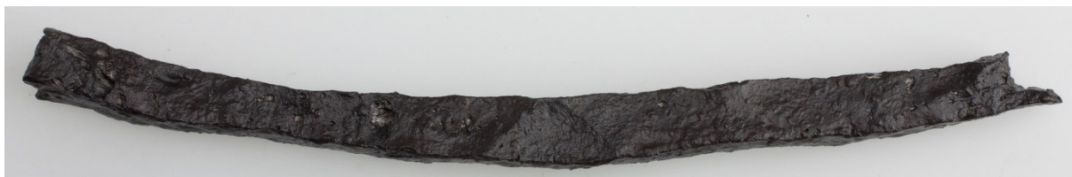
Figur 27. Järnföremål som troligen är ett ämnesjärn med fyndnr 11 (171 x 11 x 10 mm). Foto Stiftelsen föremålsvård i Kiruna.
