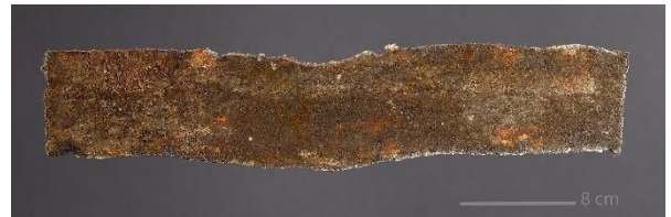
Figur 69 Vevde ulltekstiler er brukt som tetningsmateriale mellom båtboardene (.360). Dette stykket er fra tønnestav .255. Foto: M. Karlstad/Norges arktiske universitetsmuseum
