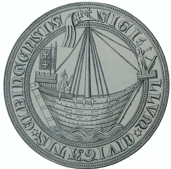
Figur 48 Bysegl fra Elbing datert 1350 som viser kogg med vantefeste for rigg. De horisontale triangelene på siden av skroget er trolig beskyttelse som ligger ved utstikkende bjelkehoder. Foto: Hanseflaggen (de-academic.com)
