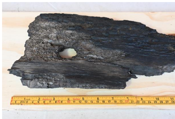
Figur 23 Eksempel på spor etter brann på hudbord x232. Foto er tatt etter at delen er konserverert i PEG og frysetørking. Foto: T. Falck/NMM
