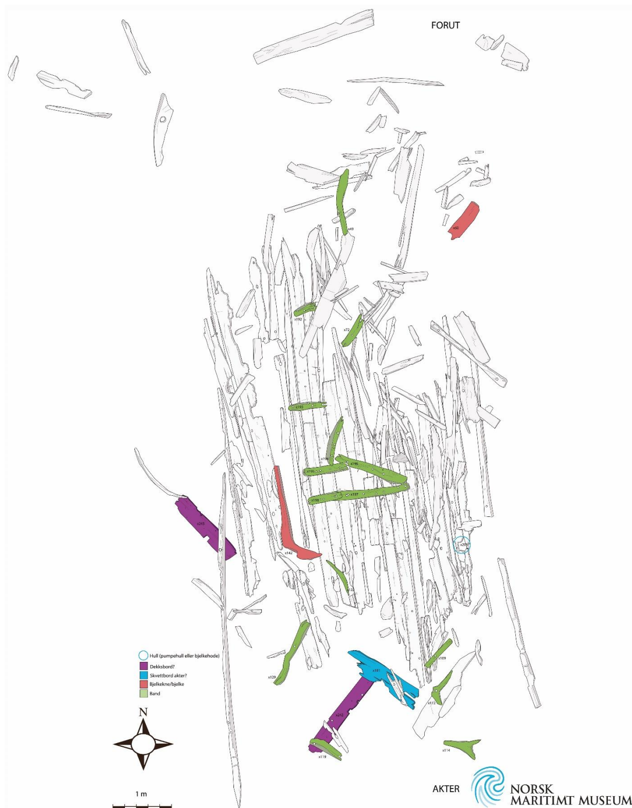
Figur 19 Plantegning med identifiserte deler: Mulig dekkbord, skvettbord, bjelke og band. Blå sirkel viser plassering av hakk i bordet x203, som kan være pumpehull eller hull for gjennomgående bjelkehode. X112 ble definert som bjelke under monteringen av båten. Tegning: S. Ahrens/R. Borvik, bearbeidet av T. Falck/NMM.
