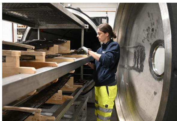
Figur 83 Konservator Monica Hovdan monterer båtdelene i spesialtilpassede former, som bordene låses i før de skal inn i frysetørkeren. Frysetørkeren er på Kulturhistorisk Museum i Oslo. Foto: T. Falck/NMM
