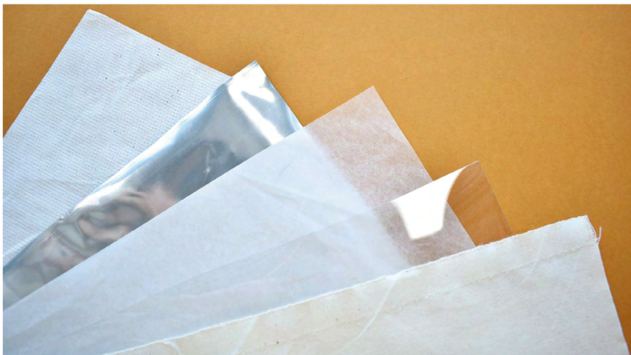
Material som nonwoven-duk av polyeten, laminerad aluminiumfolie, silkespapper, polyesterfolie och bomullsduk är vanliga material inom samlingsförvaltning. Foto: Riksantikvarieämbetet.
