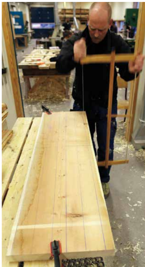
Rasmus Skrydstrup frå Nidarosdomens Restaureringsarbeider fusser opp emne til ramtre til vindauga. Ein del arbeid kan i første omgang sjå ut som ein "transportetappe" fram til arbeidet der det er mange små finessar som står fram som det mest interessante i arbeidet. Mengdetrening med slikt arbeid som er meir ein-sidig kan vere viktig for å forstå arbeidsmåten og verktøyet. Då eg fekk sage saman med den erfarne snikkaren Sjur Nesheim frå Granvin lærte eg mykje om kor raskt og effektivt ein kan sage med ei slik grindsag. Med litt trening og optimalt verktøy kan arbeidet gjerast nøyaktig og effektivt.
