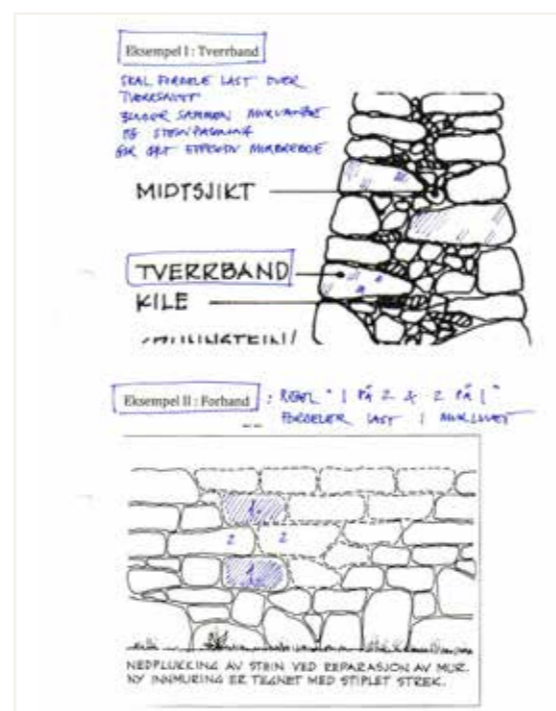
Tverrsnitt av en kistemur. Skisser av prinsipp for tverrband, produsert for Riksantikvarens informasjon om kulturminner, Detaljblad 2.2.1 Gamle steingjerder. Tegning: Mari Kollandsrud og MURING Espen Marthinsen, 2002
