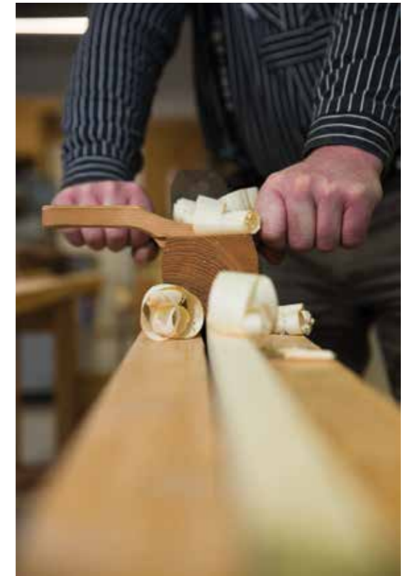
Skottoksen i bruk. Legg merke til at bordkanten ligger over benken.
