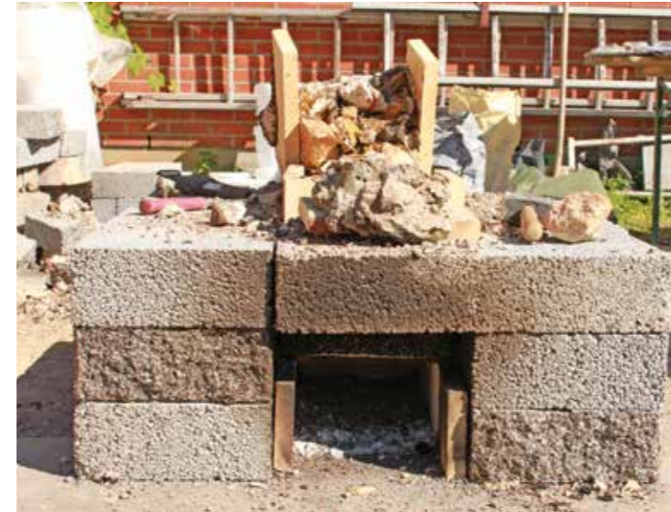
Demontert ovn med den brente, gyldne kalken synlig. Foto: Astrid Santa.
