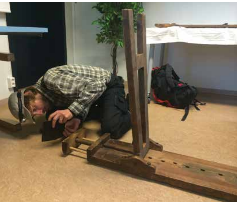
Magnus Wammen dokumenterer en høvelbenk i museets samlinger. Den er veggfast og kan klappes sammen.
