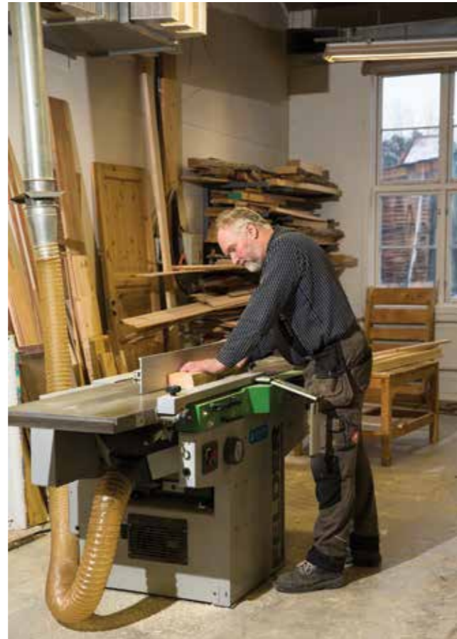
Moderne snekkermaskin på snekkerverkstedet: Tykkelses-/avretter eller kombinasjonshøvel til bruk for retting og dimensjonering av materialer.
