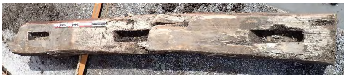
Figur 45: Stokk med rektangulære hull til skråstilte bjelker. Foto av Tom Davis, NMM.
