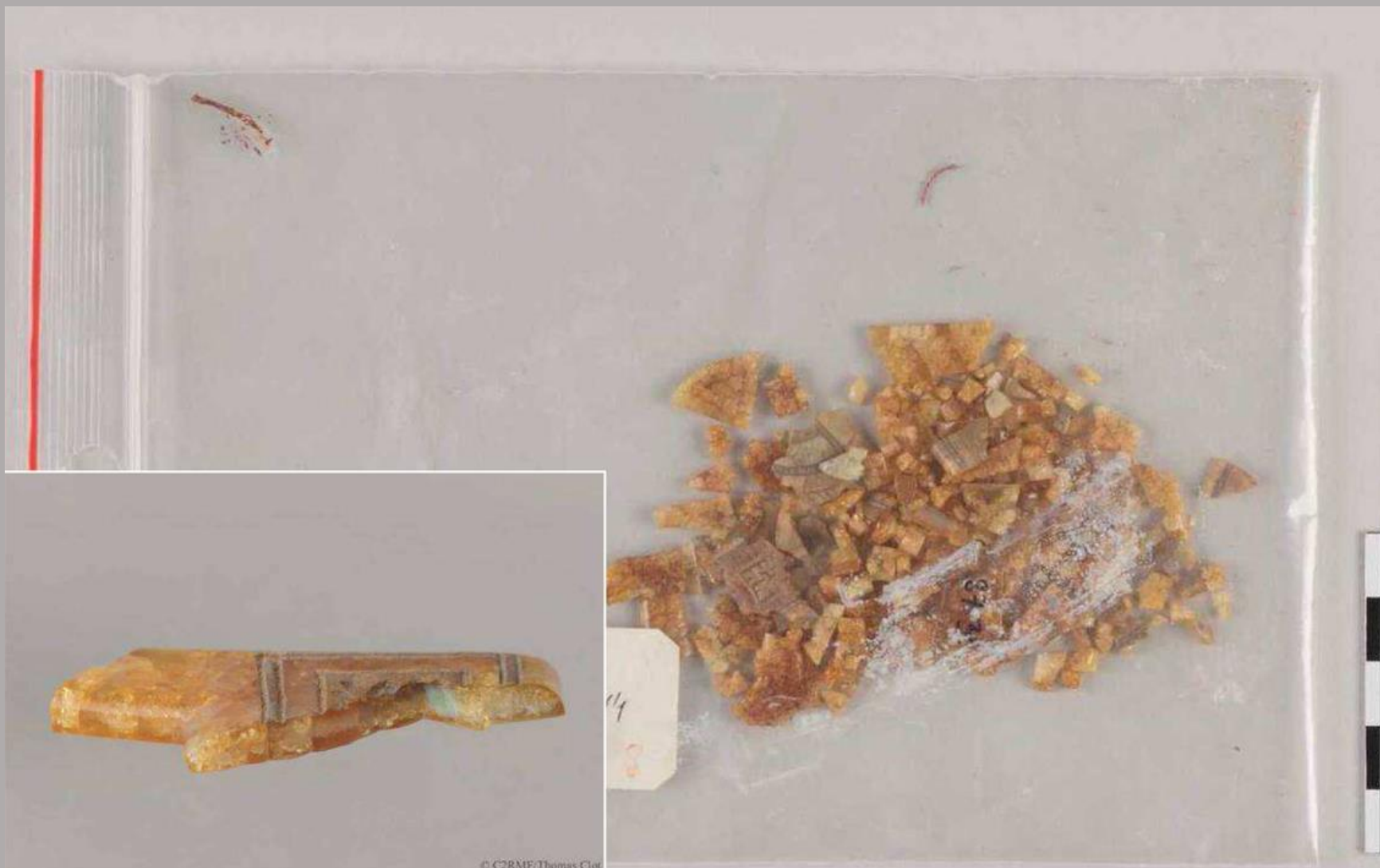
Vittrad cellulosanitrat Damage atlas, POPArt
