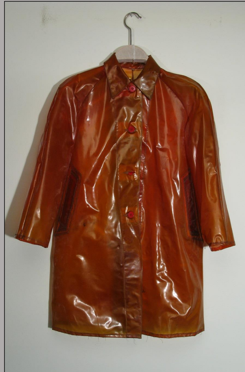
Regnkappa i mjukgjord PVC från 1940-tal. Mjukgörare har avgivits och kappan har blivit skör och stelnat. Nordiska Museets samling.
