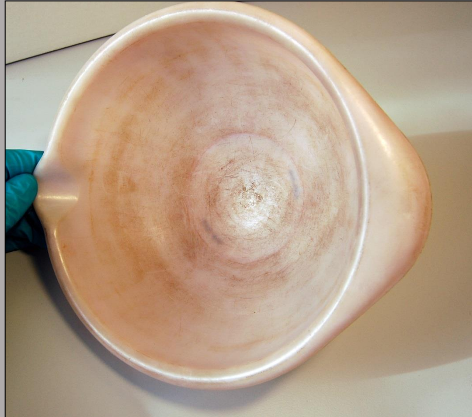
Skål av etenplast, PE, repad och med fet yta där smuts fastnat. 1950-tal. Nordiska Museets samling.
