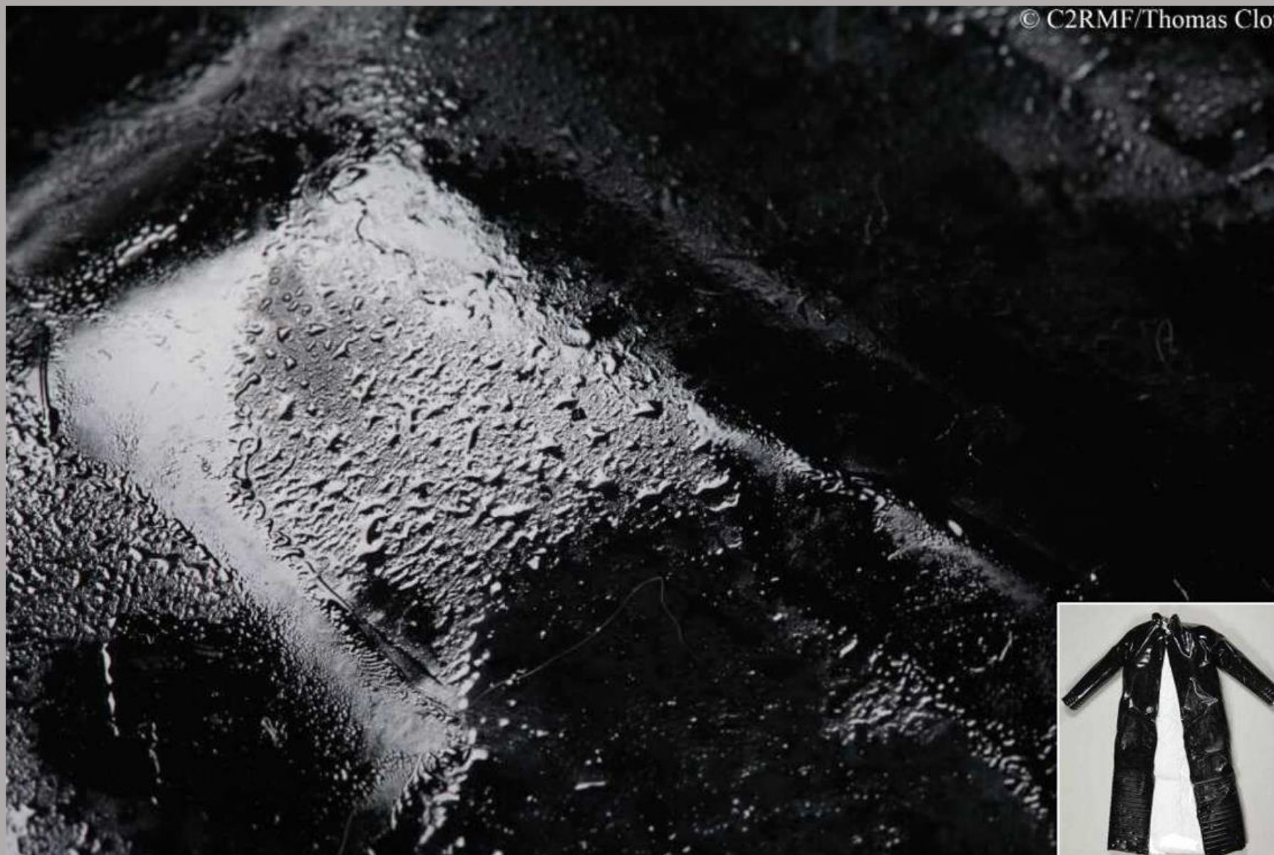
Svetteing på regnrock av p-PVC, Damage atlas , POPArt
