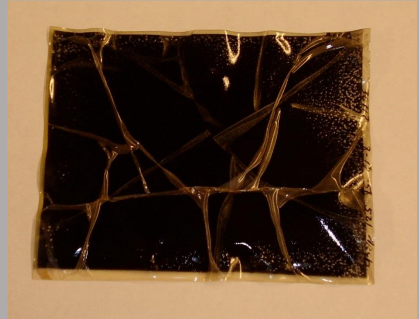
Negativ av cellulosaacetat som drabbats av nedbrytning.
