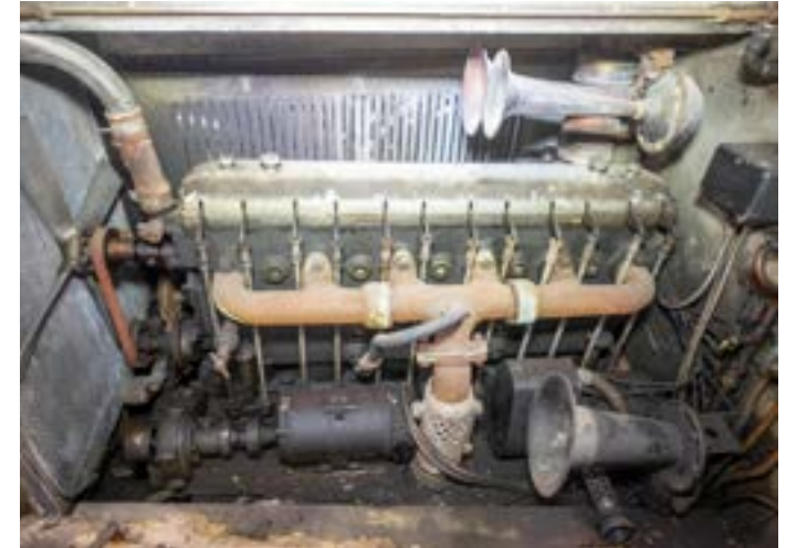
Motoren i Giganten har toppventiler, har én lavt plassert kamaksel og lange, utenpåliggende støtstenger. (Foto: Morten Reiten).
