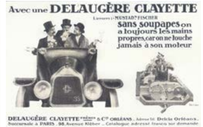
Mustads sleidemotor besto av to halvylinderformede sleider som beveget seg mot hverandre. («Konstruktion und Berechnung moderner Automobil- und Kraffradmotoren») Delaugère Clayette omtalte sleidemotoren som «Licenses: Mustad, Fischer». (Annonse fra 1914)
