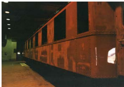
Co9b 2798 efter målning med den första lacken som hade dålig täckning, 1998. Foto: Thom Olofsson
