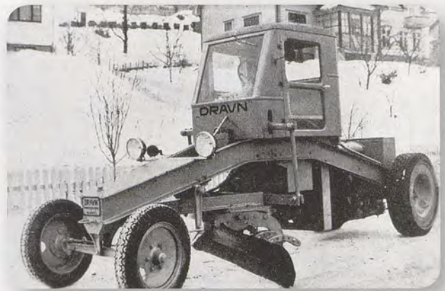
Dravn veghøvel med førerhus. Motorveghøveler kom på midten av 1920-tallet, men med et åpent maskinførermiljø. Dette er et tidlig eksempel på et forsøk på å bedre forholdene for maskinførere. Motorhøvelene var trolig til å begynne med mest brukt i vedlikeholdet. Foto: Norsk vegmuseums fotoarkiv.
