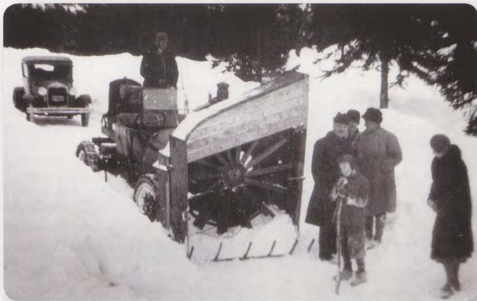
Det var mange som forsøkte å utvikle utstyr i mellomkrigstida. Denne snøfreseren fra Fagernes i 1930 fungerte visstnok bra, men den ble ikke utviklet videre. Foto: Norsk vegmuseums fotoarkiv.
