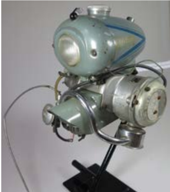
Sykkelmotor av typen Fantom Bj.52, produsert i 1952 av firmaet Norsk Cykkelmotorfabrikk i Drøbak.
