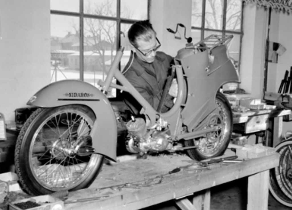
Bilde fra produksjonslinja av mopeden «Nidaros» ved Lefstads sykkelfabrikk i Trondheim i 1957. På bildet ser vi Trygve Sæterhaug monterer en baksjerm. (Foto fra Schröderarkivet, Trøndelag Folkemuseum)
