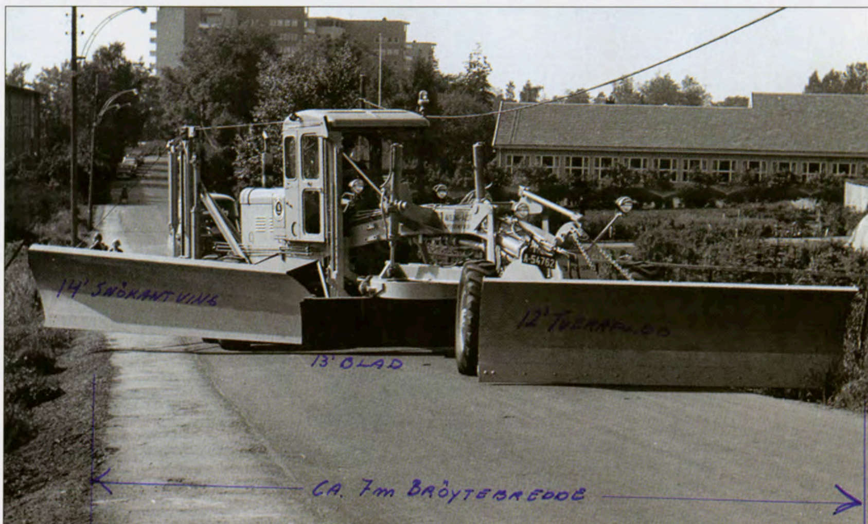
En Aveling Barford høvel i krabbegang viser alle skjær for snøbrøyting.
