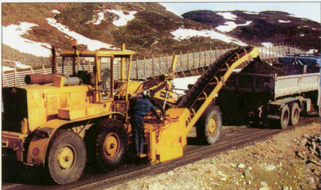
Tonstadfres med egen motor montert under rammen på veggøvelen.
