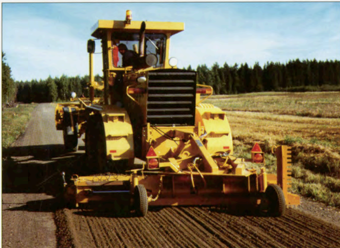
Demonstrasjon av norsk grusstrengspreder for representanter for Statens Vägverk.
