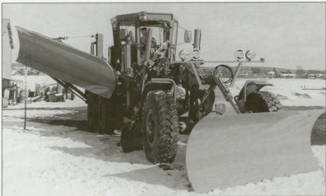
Snøkantving montert på Aveling Barford høvel.
