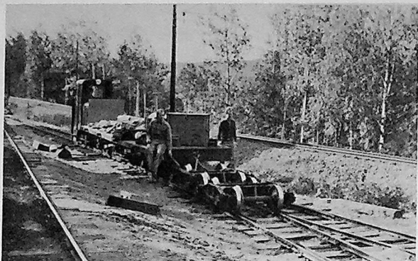
Nye reviderte boggier fra "Verkstedet Lodal- en" kjøres frem foran vognhallen.
