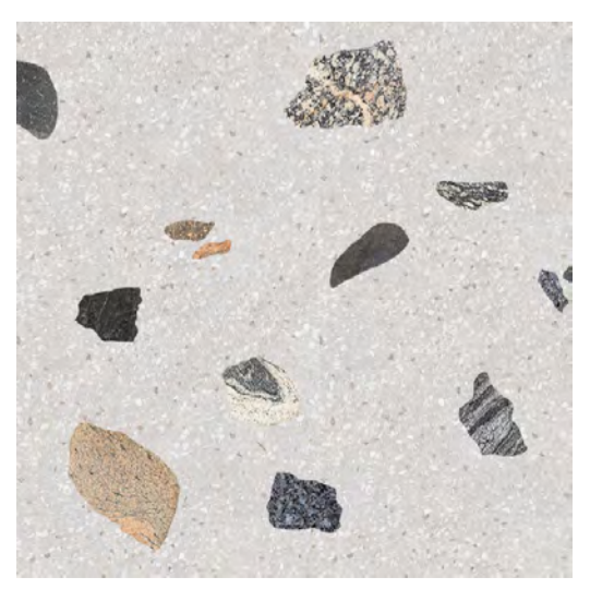
Betong med lokalt tilslag
