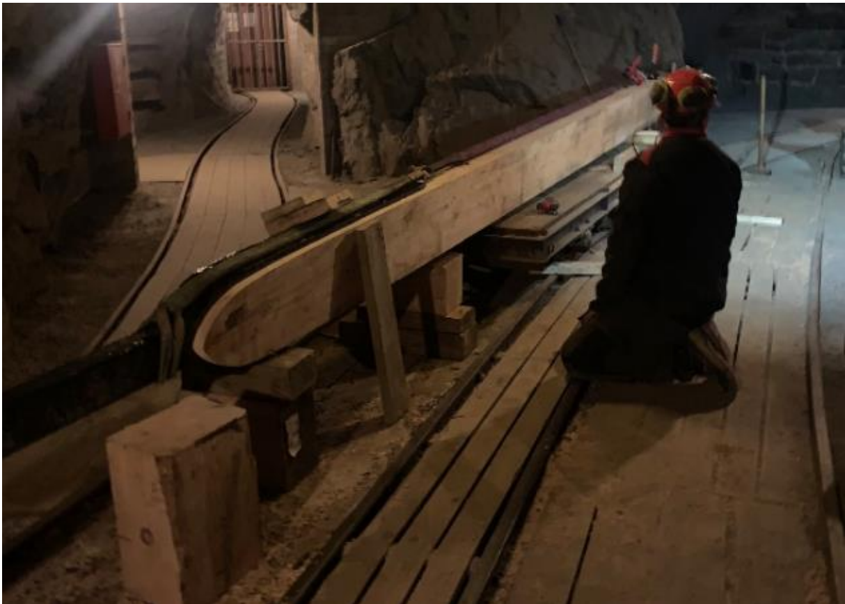
Sølvverkets første personheis, Fahrkunsten, ble tatt i bruk i 1881 i Kongens gruve. Den ble i år renoveret og bruken kan demonstreres for besøkende.
